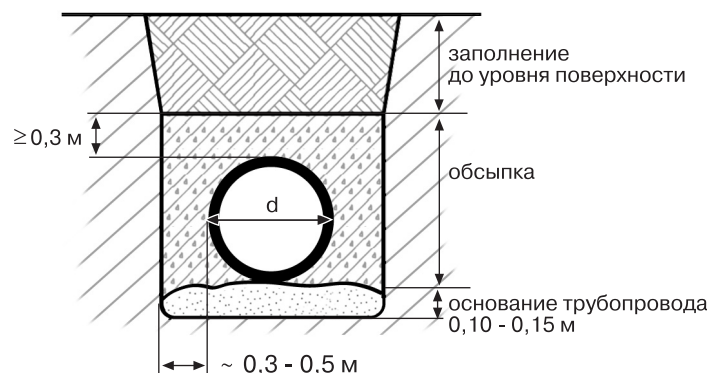
Рис. 4.1. Рекомендуемые параметры профиля траншеи
