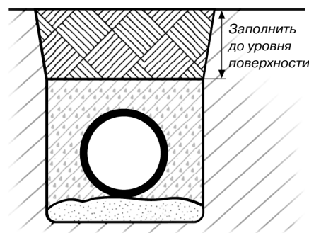
Рис. 4.5. Окончательная засыпка траншеи
