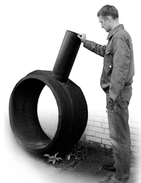
Фото 1.2. Тройник ИКАПЛАСТ неравнопроходной монолитный 1000x225 SDR 17 ПЭ 100
