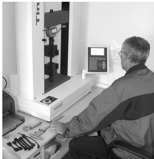
Фото 4.2.8. Испытания стыковых сварных соединений в лаборатории ИКАПЛАСТ
